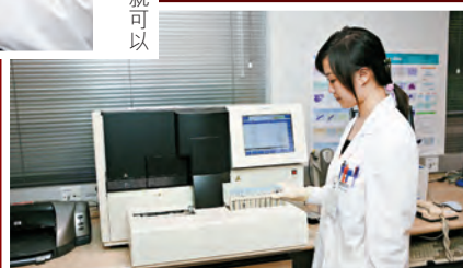
▲全自動驗血儀，可在更短時間內得知驗血結果。
